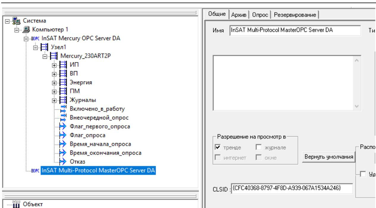
Скопируйте **GUID** в буфер обмена, выделите **Mercury MasterOPC** сервер и замените его **GUID**.
