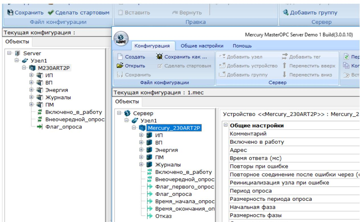
Теперь данный счетчик нужно переименовать – дать такое же имя как в **Mercury MasterOPC** сервере. Это производится аналогично, как и для узла.
